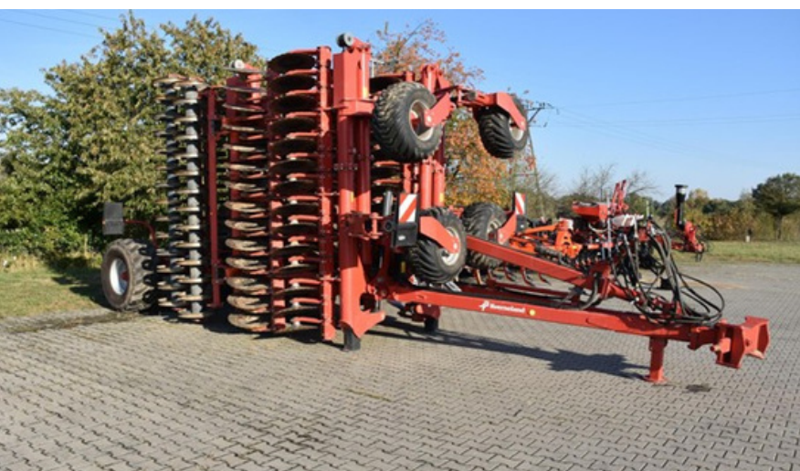
W agregacie został zastosowany system składania portfelowego, dzięki któremu wysokość maszyny umożliwia transport po drogach publicznych
