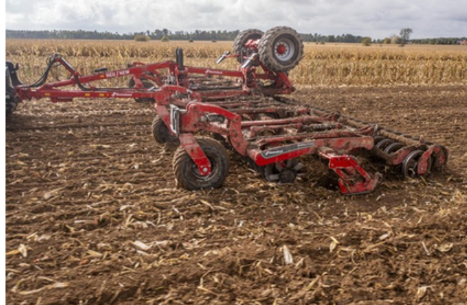
Każdy z czterech modułów talerzówki wyposażony jest w odrębne koło
