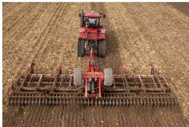
Nowa talerzówka Qualidisc 21123 o szerokości roboczej 12,25 m. Agregat składa się z czterech niezależnie montowanych segmentów ramy
